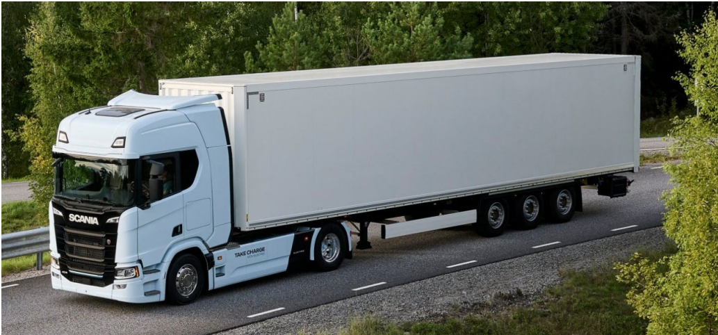
Bild: Scania Batterikapacitet: 624 kWh ger 440 km räckvidd med en tågvikt på 40 ton (ca 15 kWh/mil)
